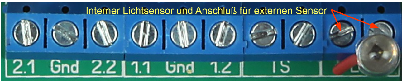
Abbildung 1: Klemmleiste des Klappenstellers HK und HK_ZSU
